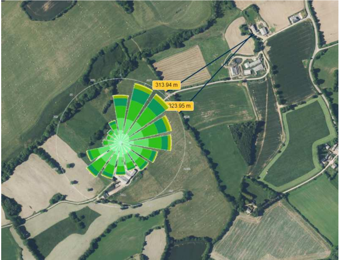
Figure 61 : Sens de dispersion des émissions atmosphériques
